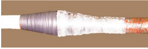
Différentes solutions de réducteur géométrique Different applications of geometrical stress control
